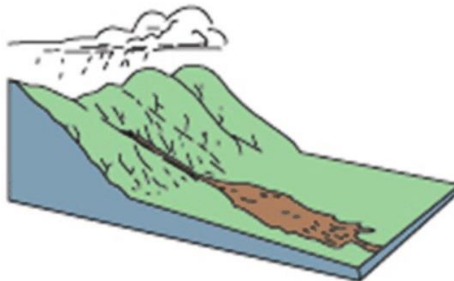
Imagen 2: Flujo de Detritos.
