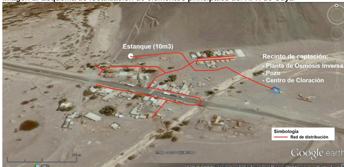
Imagen 1: Esquema de localización de elementos principales del APR de Cuya
